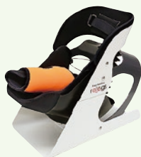
足首関節の曲げ伸ばしをサポ ートするパワーアシストレッグ 「relegs(リレッグス)」
