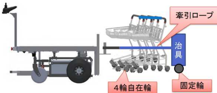
買い物カートをバンドでひとまとめにし、ロボットと固定輪の間に挟むことで運搬可能
