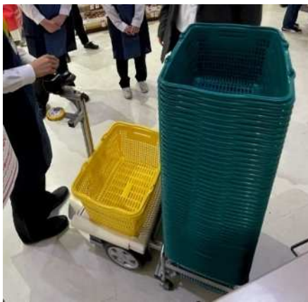
ロボットと買い物カゴ台車を連結することで運搬可能
