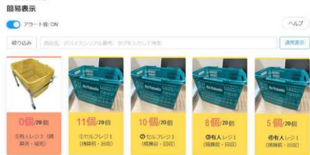
スマートマットに乗っている物の重量を検知、可視化することでカゴの滞留量を把握
