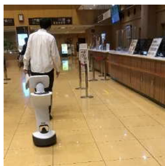
マッピング作業（追従移動で走行エリアを記憶）
